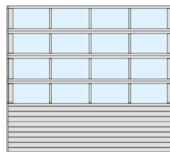
BRAMA Z PANELAMI Z SEKCJĄ ALUMINIOWĄ PRZESZKLONĄ
